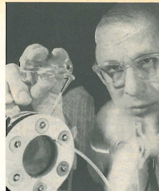
Fig. 3 - Pila a combustibile che utilizza benzina purificata ed alimenta un ventilatore.
